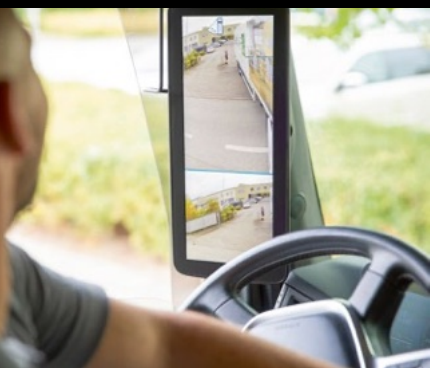
Im Actros ist eine MirrorCam installiert
